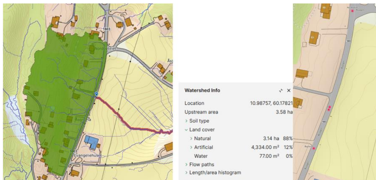
Figur 35 viser stikkrenner og nedbørfelt etter figur 20.
