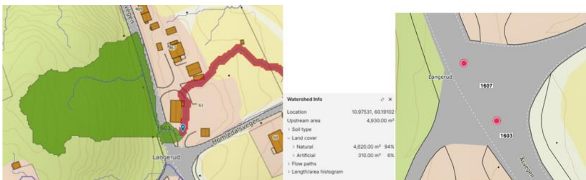
Figur 43 viser spissavrenningen og stikkrenner ved Åsvegen 467.
