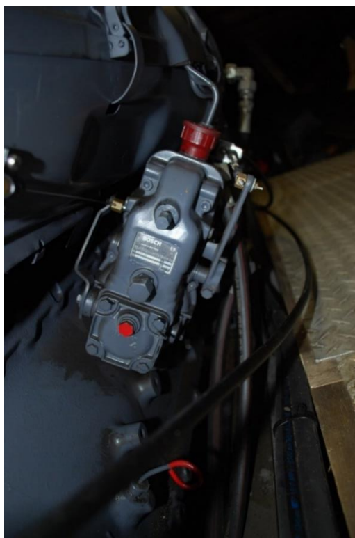
Dieselpumpa, styrer mengde diesel som en forgasser.
