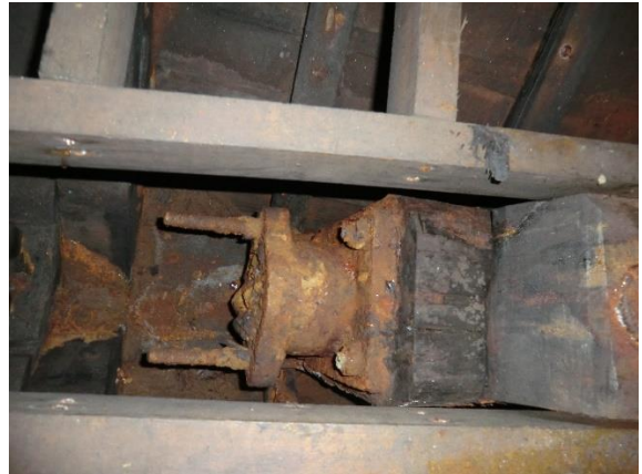
Pakkboksen for tidligere fremdrift som pendelferge med propell i begge ender. Foto: Promhavn Slipp AS
