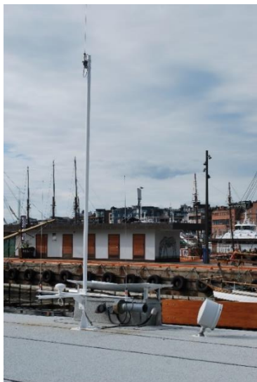
Antennemast, lys og eksos/luftavkjølingsuttak – motor, BB-side.
