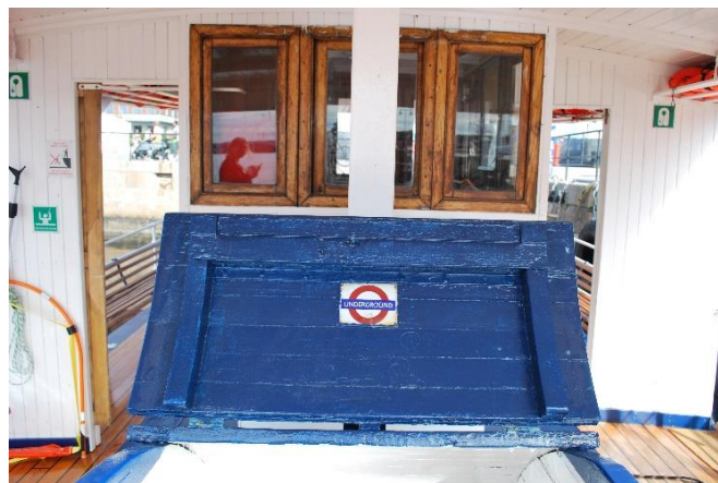
Luke nedgangskappe til maskinrom.
