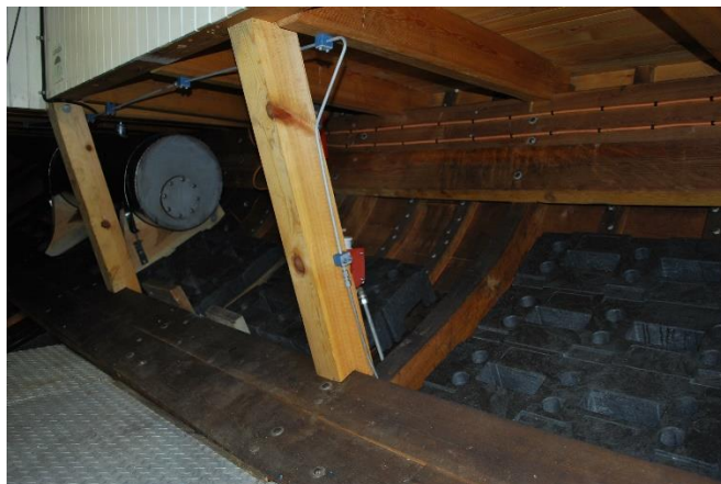
Ballast og spant – BB ved skylight.
