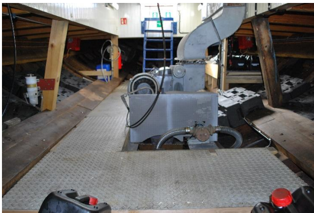
Dørken omkring motor er dekket med platedekk/rifledekk.
