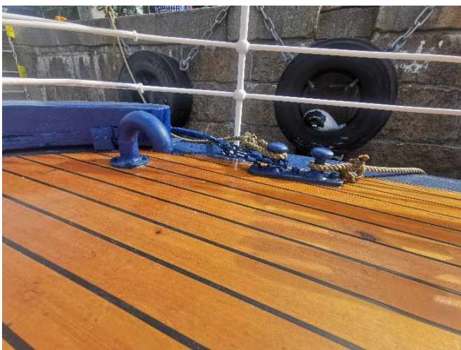
Pullere og svane-hals for lufting – SB-side.
