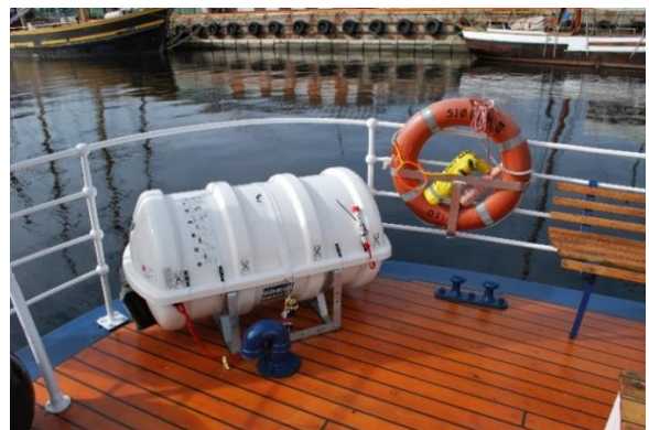
Benk, feste til redningsbøyle, puller og svanehals til lufting, BB-side.
