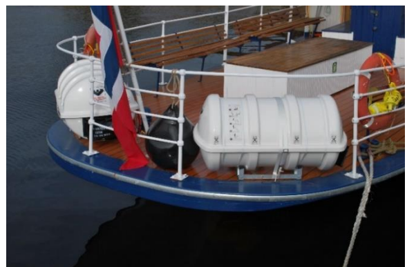
Åpningen i hekken fra pendelfergetiden er i dag lukket. Dette ble sannsynligvis gjort i 1970 i forbindelse med ombygging av dekkshus og motorbytte. Bildet fra 1977 i historiedelen over bekrefter lukket hekk med dagens løsning for flaggstang.
