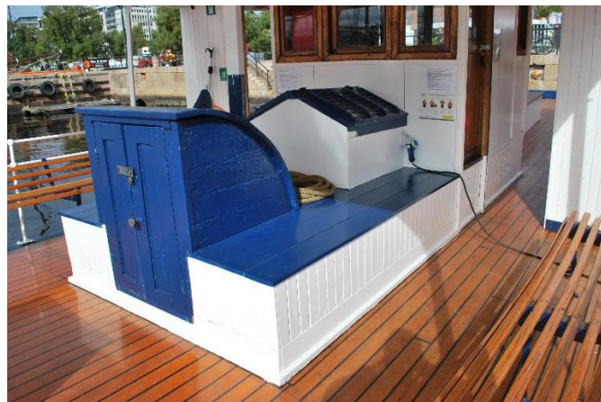
Nedgangskappe maskinrom og skylight er i sin helhet bevart fra driftstiden etter restaurering.
