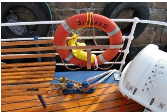
Benk, feste til redningsbøyle og puller, SB-side.
