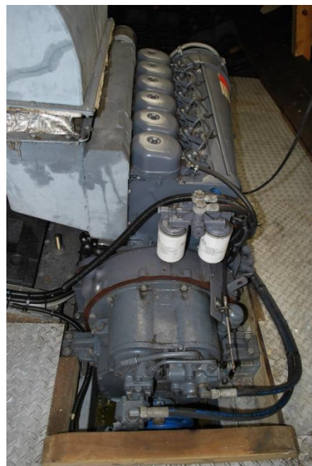
Deutz 6FL 914, diesel 4-takt, luftkjølt, 79 bremsehesterkrefter.
