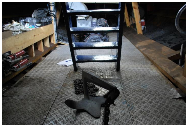
Rifle-dørk over propellaksling – motorrommet.
