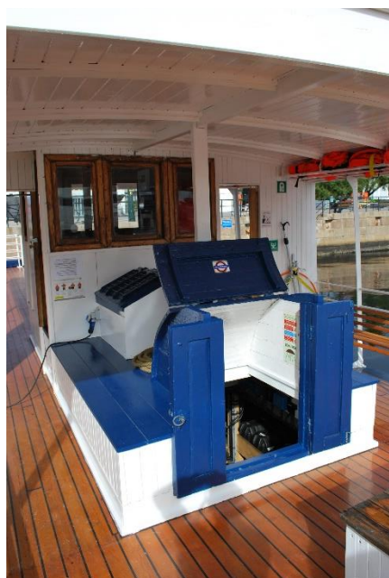
Nedgangskappe til maskinrom.
