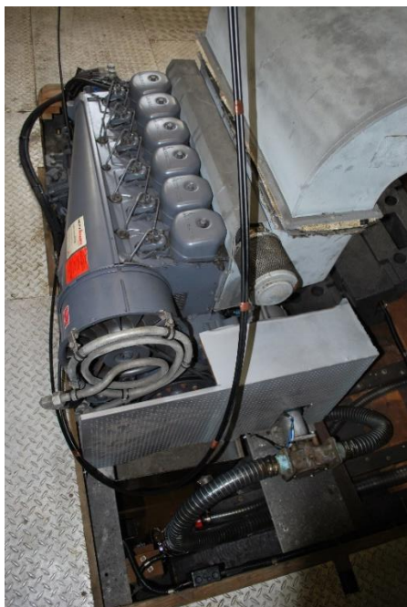
Deutz 6FL 914, diesel 4-takt, luftkjølt, 79 bremsehesterkrefter.
