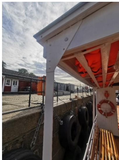
Opprinnelig stender og stålprofil – takoverbygget - fordekket.
