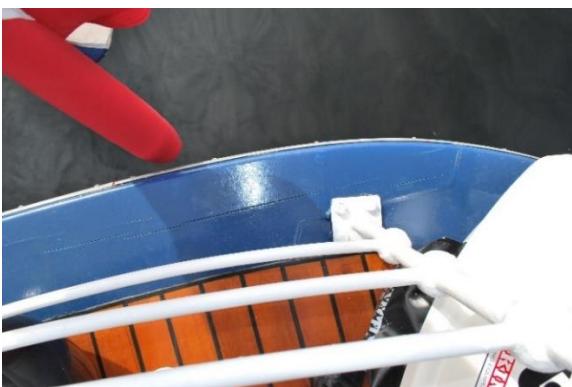
Feste til septer/rekkestøtte på fenderlist.
