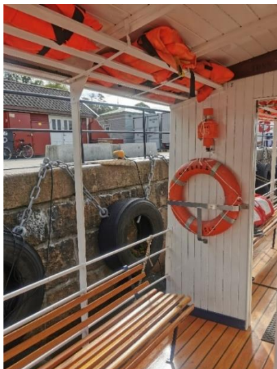
Innvendig takoverbygg med redningsutstyr, SB -side. Benkerad. Skilleveggen hadde i eldre tider dør.
