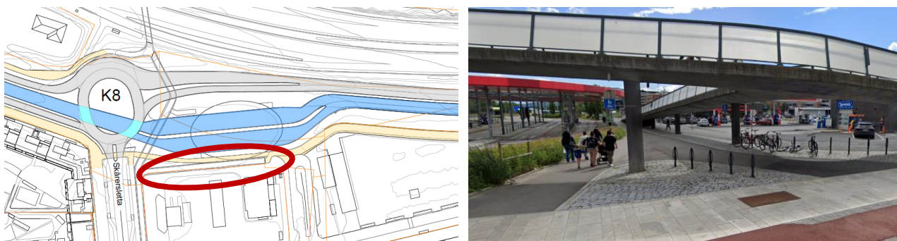
Figur 5.27. Problemområde for sykkel langs bussterminalen. Det er for smalt for sykkel langs terminalen, og ikke mulig å utvide på grunn av gangrampen som er koblet til broa.
