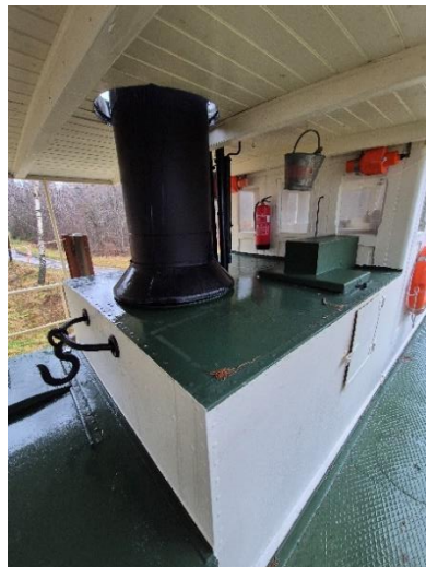
Skorsteinsgjennomføring, krok for tømmertrekking.
