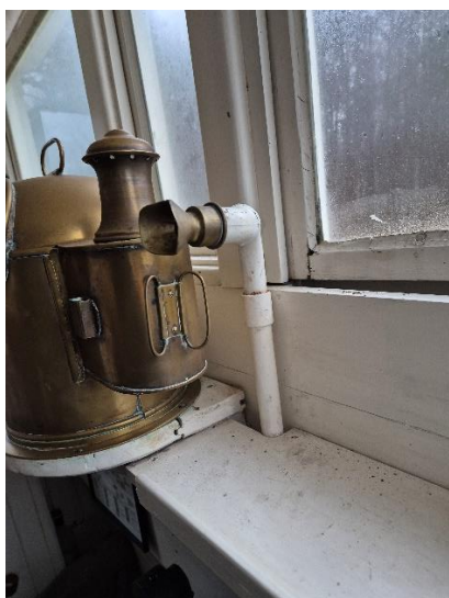
«Talatuten» man blåser i til fløyten i maskinrommet.
