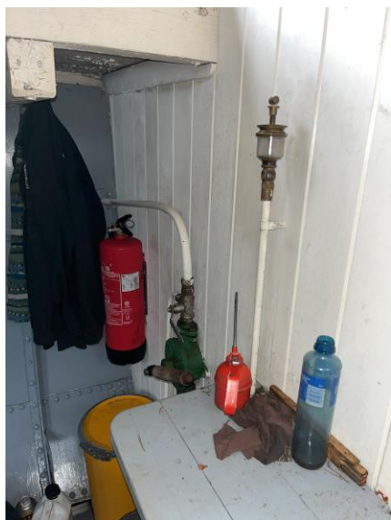
«Har du satt på lilletiss» - smøring til lager på aksling.
