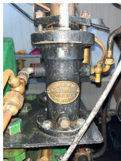
Smøreapparat – produsert av Vulkan, No 2, LNo 9862, Patent, Kristiania
