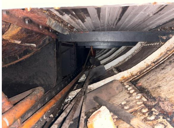
Skutesiden under dørken på styrbord side. Til venstre deler av kjelen.
