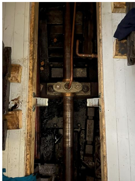
Hylse, propellaksel. Kobberrøret kommer fra den såkalte «lilletiss» som smører akslingen.
