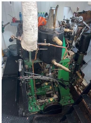
Omkaster, hoveddampprøret og pådrag til maskinen. Gulltappene kalles sikkerhetsventiler på maskinen.
