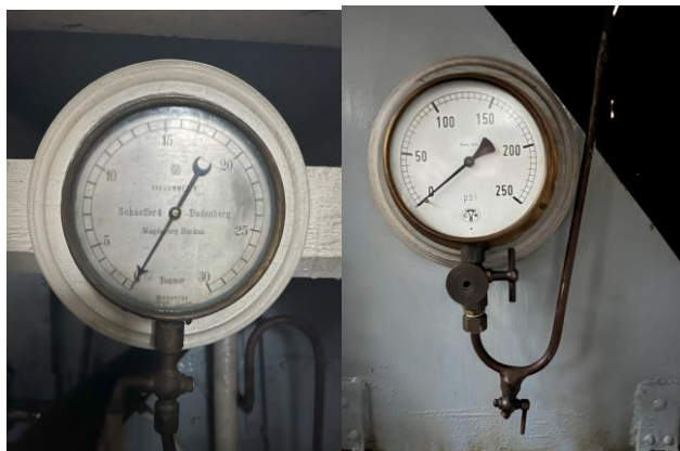
T.v. Vakuummåler, produsert av Schaffert Budenberg, Magdeburg Buchau. Th. Trykkmåler av ukjent fabrikat. Initialer CK.
