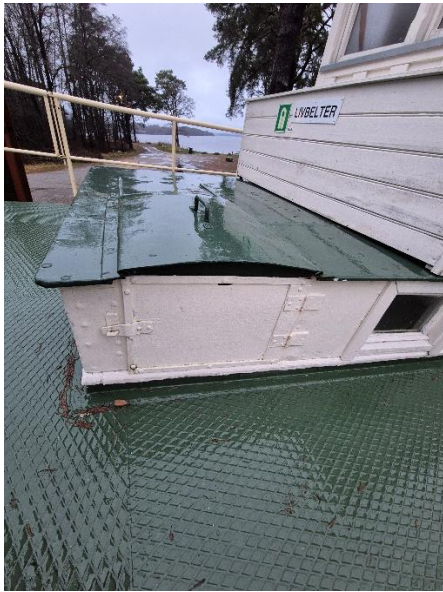
Nedgangskappe/casing til mannskapslugar forut.
