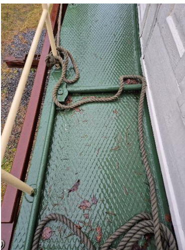
Rifledekk, rørgjennomføring for kjettingsstyring.
