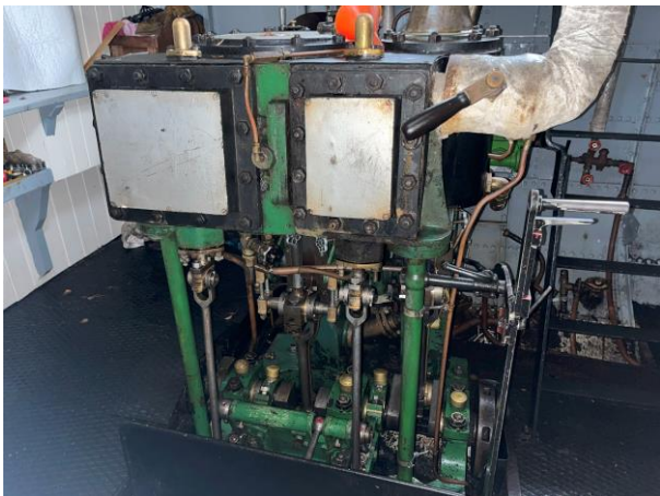
Maskin – typisk sideblikk på en compound maskin, altså to-sylindret dampmaskin. Marshall-type på «Sooten».
