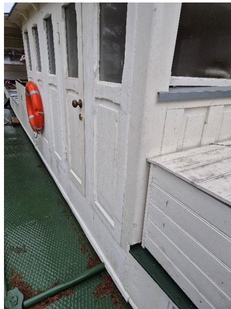
Styrbord side, styrhus. Legg merke til rørgjennomføring for kjettingstyring.
