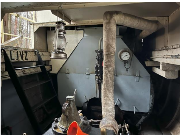
Røykkasse/fyrkassa – også kalt «kjerka» i bakkant. Det første som ble påbegynt istandsatt på båten fra 1989. Til venstre synes kjenningssignalet på båten. I forkant hoveddamprør fra kjelen til maskinen.
