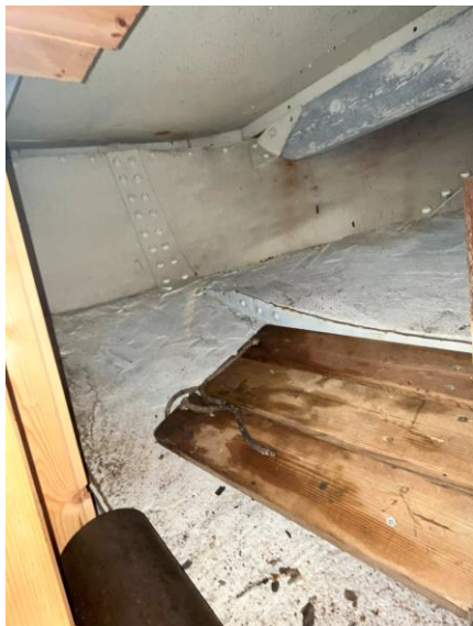
Skott for rorgjennomføring. Klinket platekledning.
