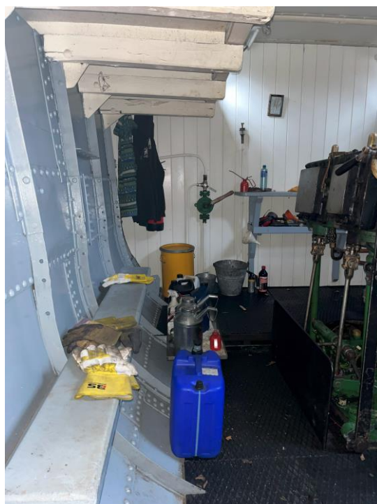
Styrbord side, maskinrom. Manuelt lenseapparat på skottet akter.
