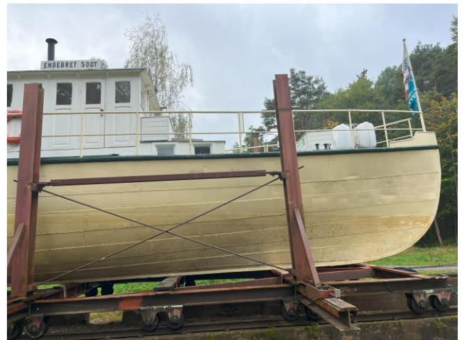
Klinket skrog – styrbord side. Mange skrogplater er de samme som fra siste driftsperiode.
