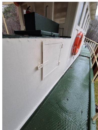
Mannelokk til styrbord kullbaks. Inspeksjonsluke kjele.
