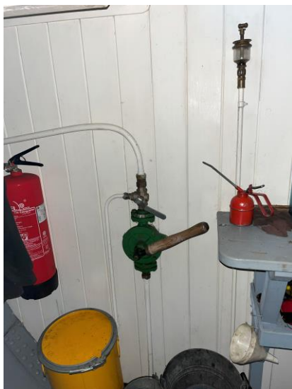
Manuelt lenseapparat på skottet. Den gule boksen er fylt med sagflis blandet med parafin til oppfyring i kjelen.
