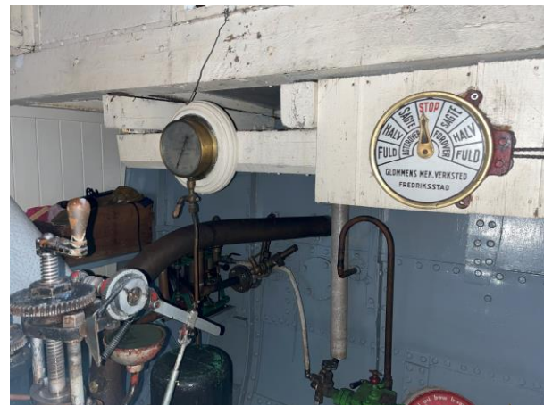
Til venstre: Vakuummåler, til høyre maksintelegraf. Nederst til venstre – smøreapparat til høytrykkssylinder. Babord side.
