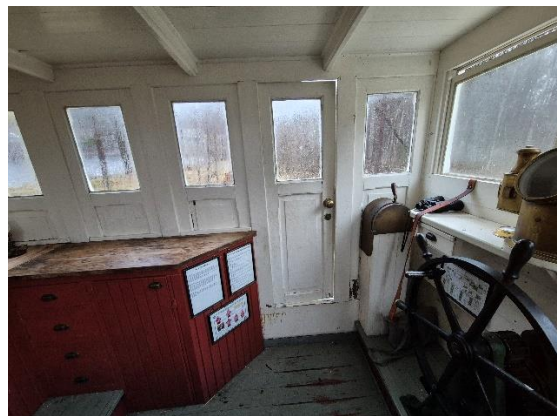
Skap, maskintelegraf og styring, babord side.
