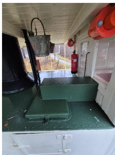
Kjelecasing og kasse til wirere/systemet som utløser nødventil i maskinrommet fra styrhus.
