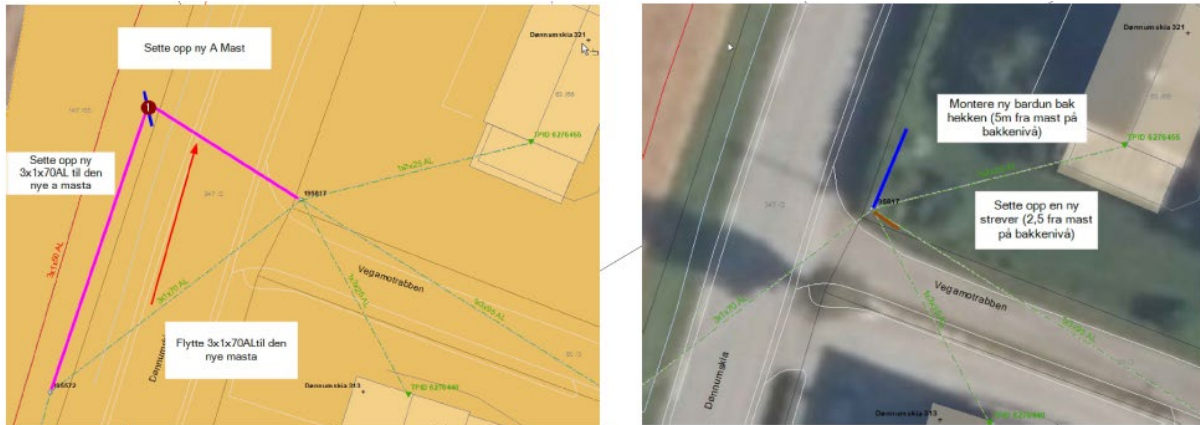
Figur 16. Viser to alternative måter for å forankre mast ved Vegamotrabben uten å komme i konflikt med planlagt gang- og sykkelvei.
